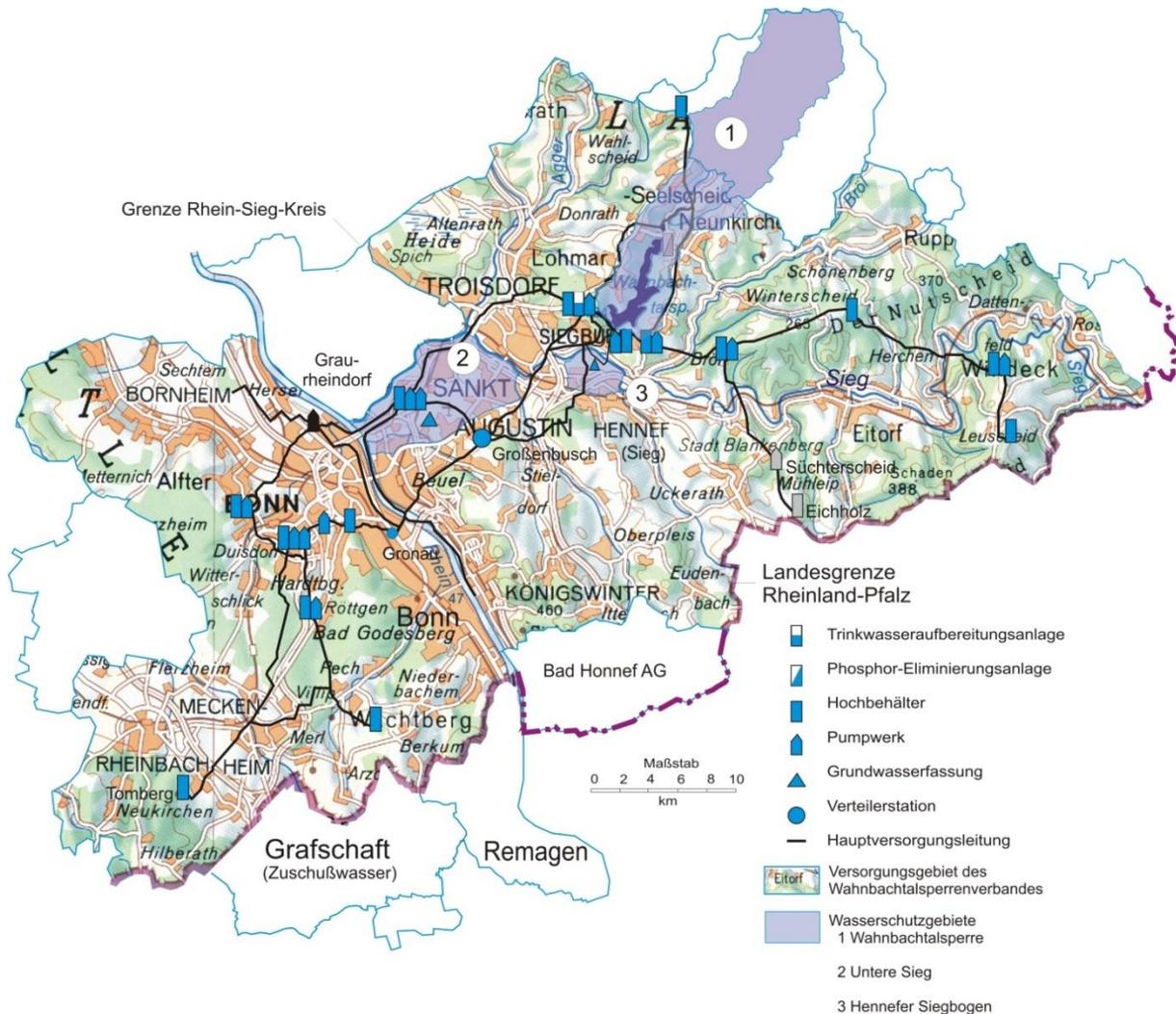
Abb. 2.1.3.1: Übersichtsplan – Wassergewinnungsanlagen/-gebiete (Wasserschutzgebiete) des Wahnbachtalsperrenverbandes
