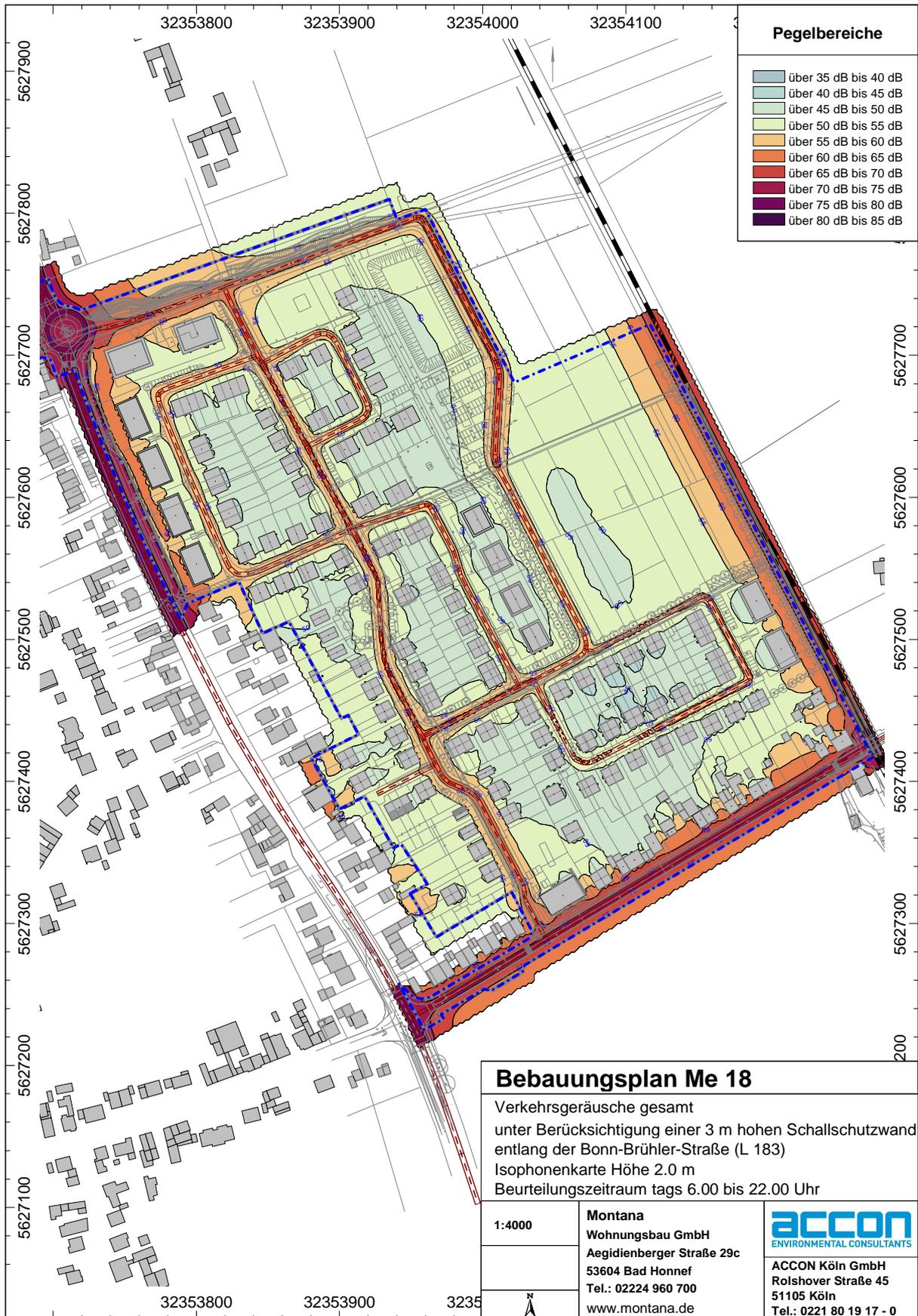
**Abb. 4.3.1** Verkehrslärmimmissionen in den Außenbereichen (Höhe: 2 m) unter Berücksichtigung einer Schallschutzwand im nördlichen Bereich an der Bonn-Brühler-Straße - Bebauung gemäß Konzeptentwurf -
