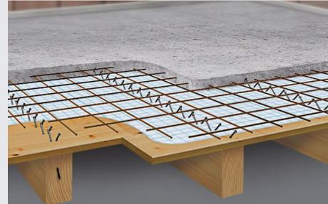
Model einer Holz-Betondecke
