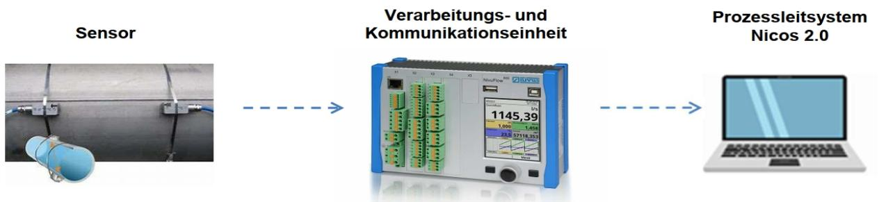
Hierbei wurde der Ort Installation so gewählt, dass ein Vergleich des Messverhaltens gegenüber dem Zählverhalten eines Flügelradzählers möglich war. Im Bereich der Messstelle Kuppenberg Schornsberg war es möglich die Messung so zu installieren das ein direkter Vergleich mit einem Flügelradzähler unter dem gleichen Volumenstrom möglich wurde. Die übermittelten Daten wurden in unserem Prozessleitsystem erfasst, beide Messungen in einem Diagramm übereinander gelegt.
