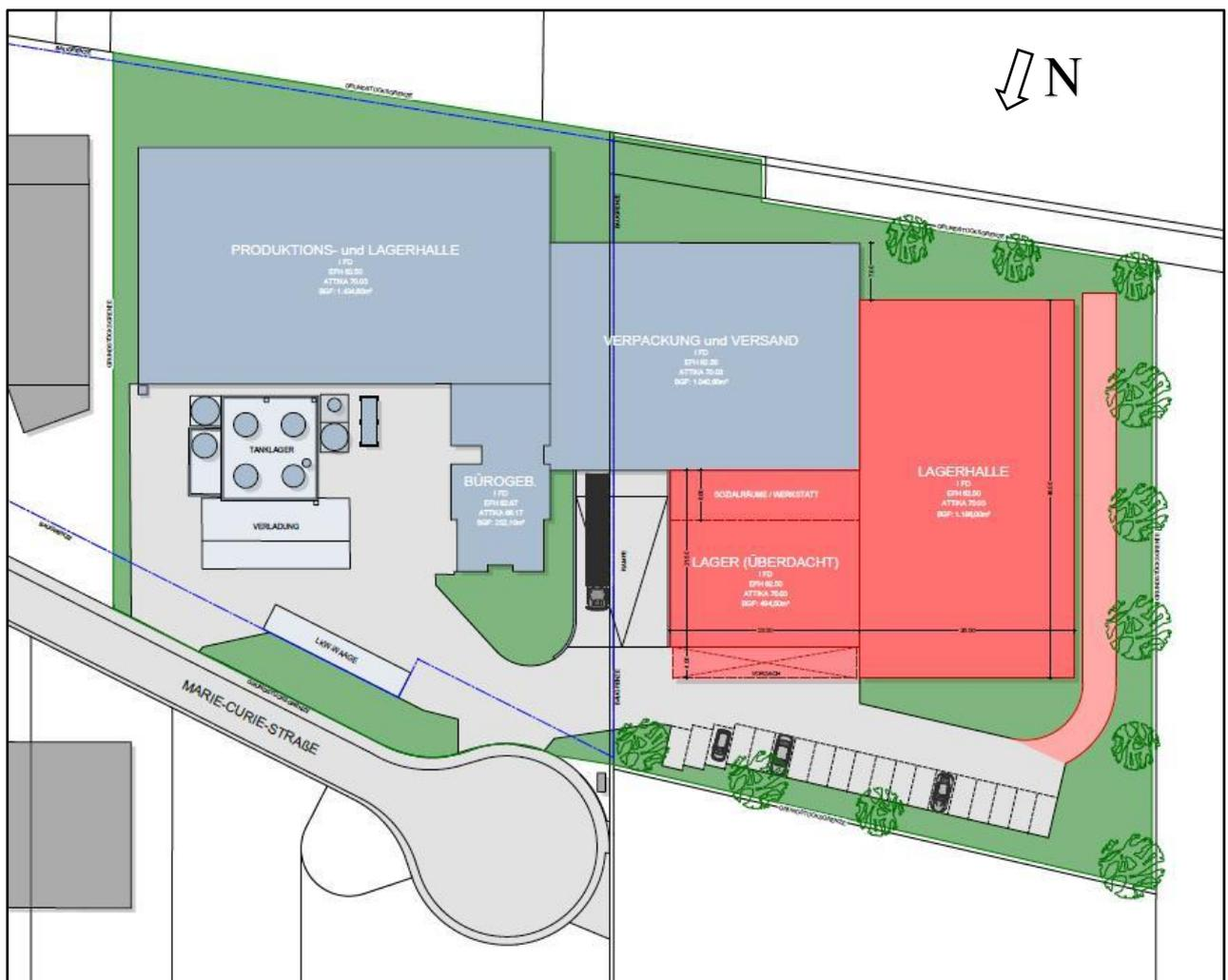
Abb. 8: Darstellung der geplanten Hallenerweiterung
