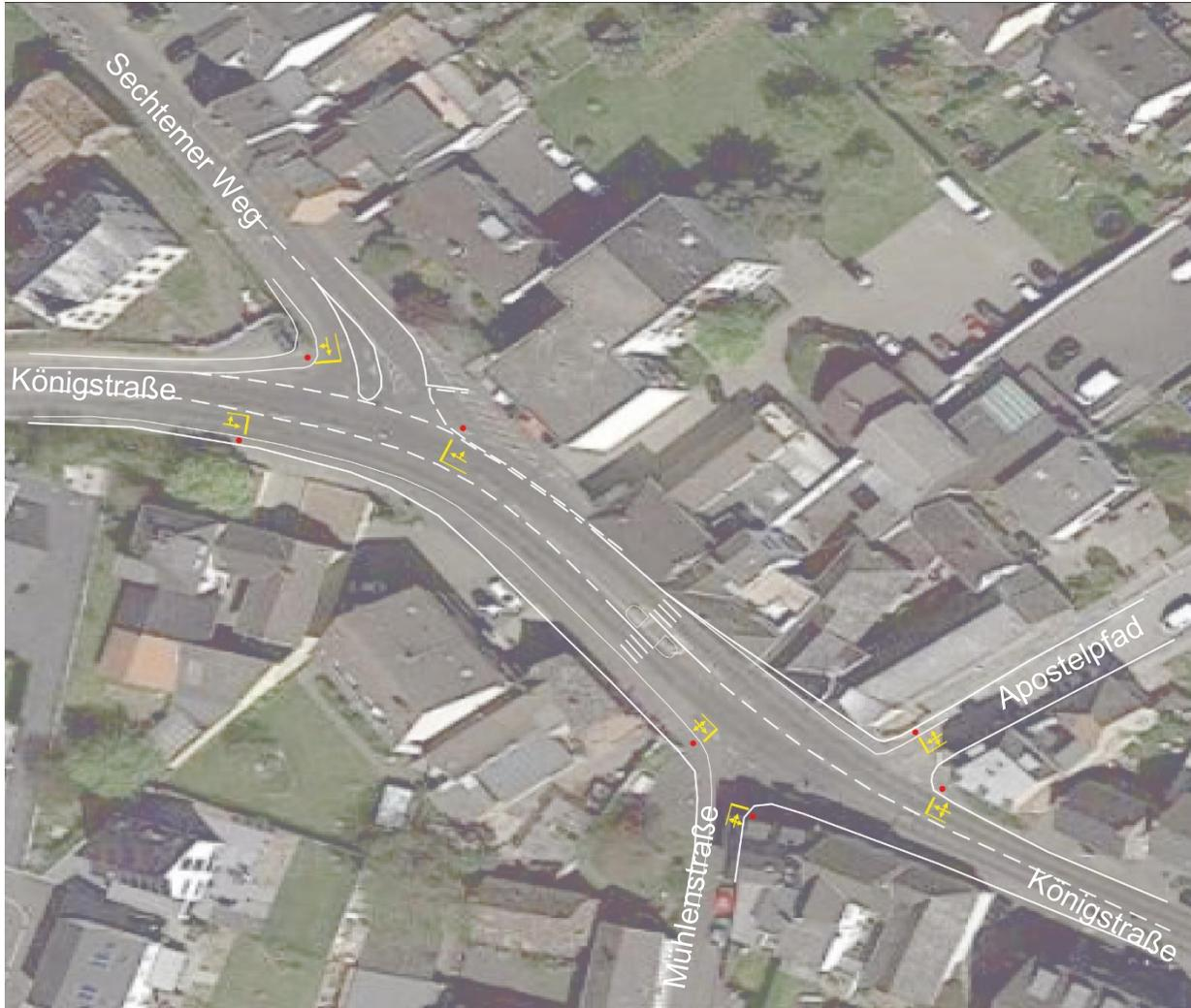
System mit 2 separaten Signalsteuerungen ( $T_u = 95s$ )
