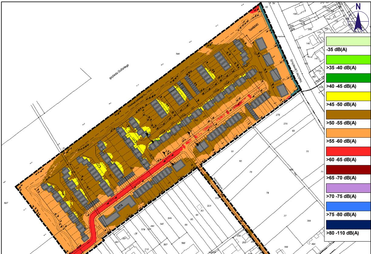
**Lärmkarte 3.EG.T-MM: Verkehrsgläusche Tag im EG/Freifläche mit der 3,5 m LS-Wand, M 1:3.500**
