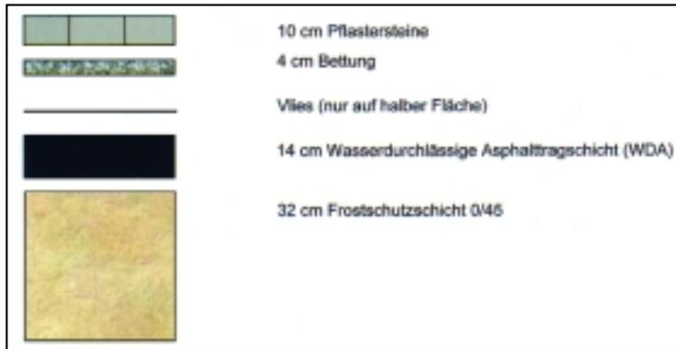
Abb. 6: Geplanter Oberbau für die Versuchsstrecke
