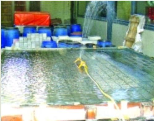
Bild 1: Fehlendes Wasserableitvermögen im Versuchsfeld 2
