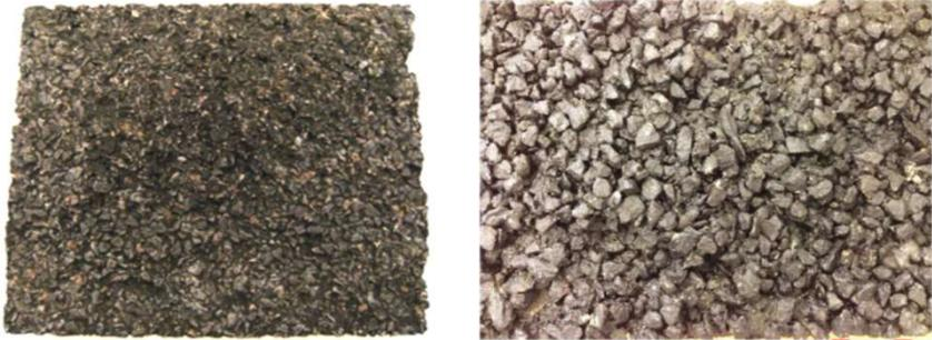
Belastete PA 8 Probe nach 150 min
