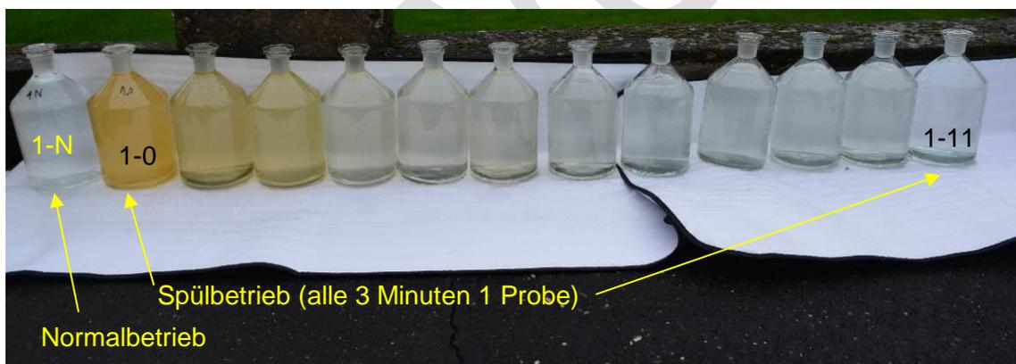
**Abbildung 9: Netzbeprobung Landgraben, Nov. 17**
