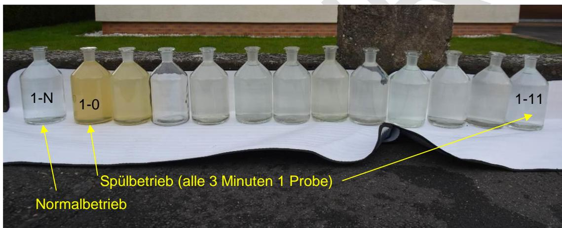
Abbildung 14: Netzbeprobung Landgraben, Mrz. 18
