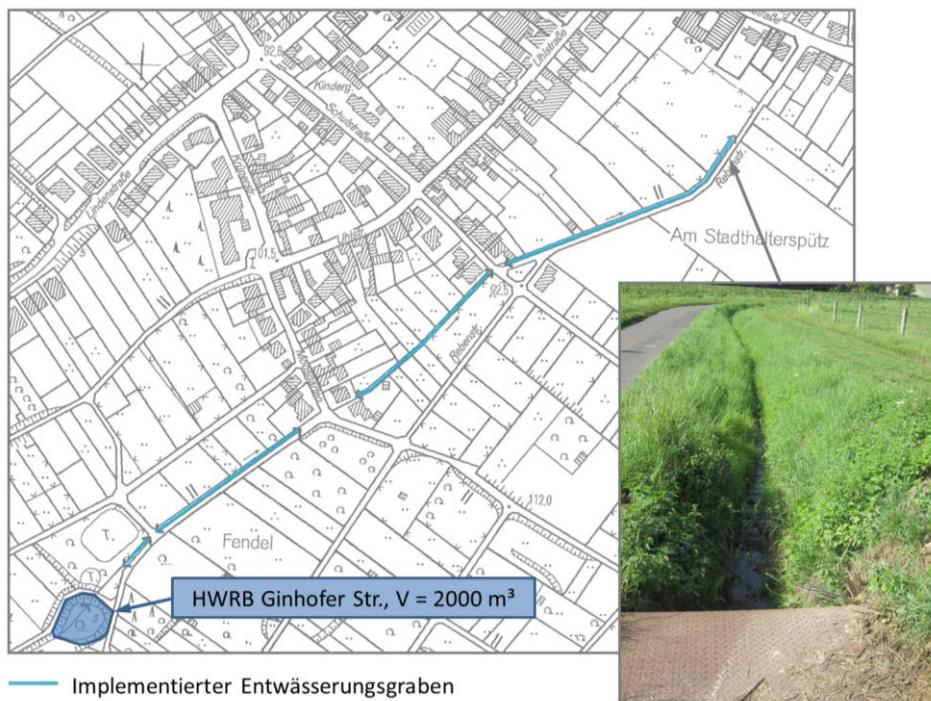
Bild 2 In das Kanalnetzmodell implementierter Entwässerungsgraben
