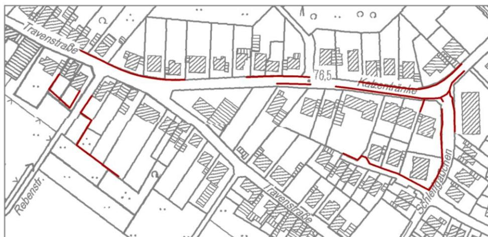
— Im Modell implementierte Bruchkanten auf Basis vermessungstechnischer Aufnahmen
