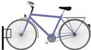
Reine Vorderradhalter sollen heutzutage nicht mehr verwendet werden, da eine Beschädigung des Vorderrades nicht ausgeschlossen werden kann.
