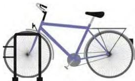
Gabelhalter verhindern die Beschädigung des Vorderrades, indem die Gabel und je nach Rahmengeometrie auch ein Teil des Rahmens angelehnt werden können. Teilweise sind noch zusätzliche Elemente angebracht, die ein Wegrutschen des Vorderrades verhindern.
