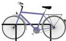
Eine Weiterentwicklung des klassischen Anlehnbügels ist der Anlehnbügel mit Vorderradhalterung. Er vereint Vorteile des Anlehnbügels mit denen von Gabelhaltern indem er dem Vorderrad einen zusätzlichen Halt verschafft. Bei einer einseitigen Nutzung sollte der Abstand der Bügel mindestens 70 cm betragen. Da die Räder bei doppelseitiger Nutzung gegenläufig abgestellt werden, kann der Bügelabstand in diesem Fall auf 90 cm reduziert werden.
