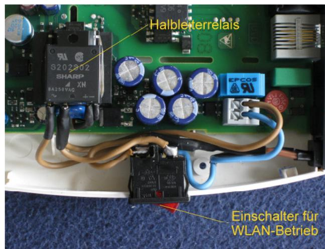
**Bild 4.** Modifikation WLAN-Schalter und Halbleiterrelais
