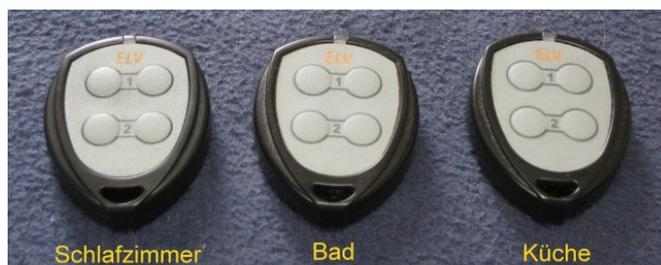
**Bild 4.** einheitliche Handsender für die verschiedenen Räumlichkeiten
